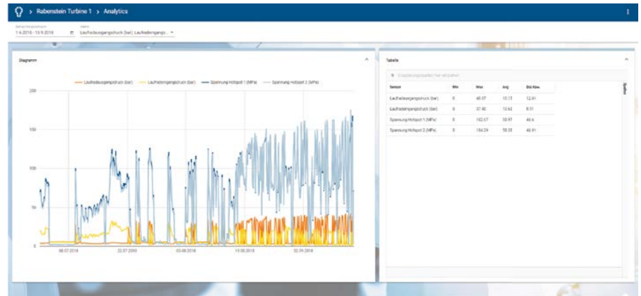
Bild 3: Ein Dashboard liefert in Echtzeit eine Gesamtübersicht über die Rabenstein-Turbine 1, wobei die Daten von Sensoren und virtuellen Sensoren sowie die Restlebensdauer dargestellt werden.
